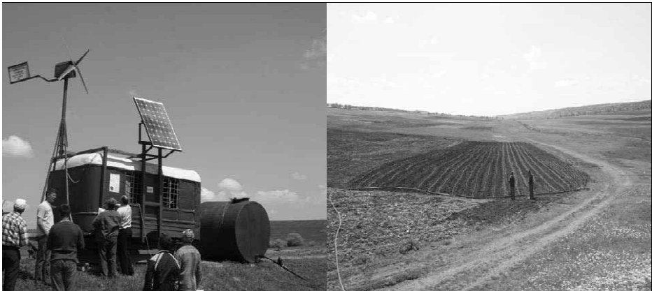
Организация капельного орошения с использованием возобновляемых источников энергии (солнце, ветер). Комратский район, село Авдарма
